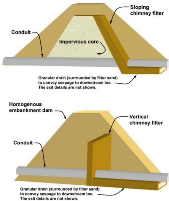
Figure 12: Conduit Filter Protection
